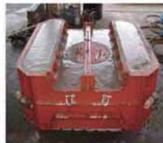
③コテ均し、養生
