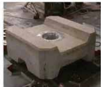
④型枠脱型
